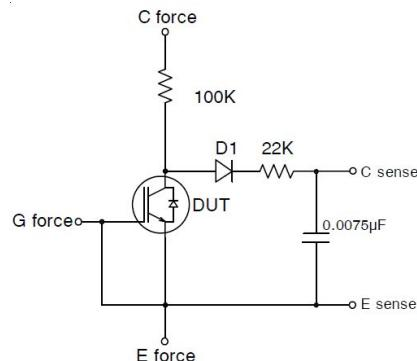
**Fig. 6 - BVCES Filter Circuit**
